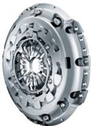
Foto 1: Płyta dociskowa z widocznymi przetłoczeniami obudowy i sprężynkami regulacyjnymi
