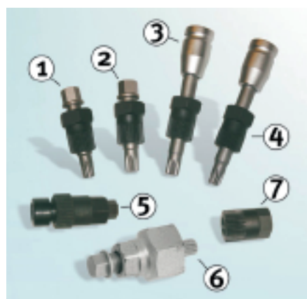
Foto 5: Specjalne klucze do montażu i demontażu sprzęgiełek alternatora
