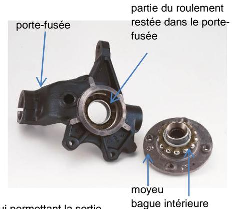
4. si l'anneau de billes est resté sur le moyeu le retirer à l'aide d'un extracteur. Les mors de serrage prennent appui dans la gorge de la bague intérieure du roulement. Si la bague intérieure n'a pas de gorge prendre appui entre les faces de la bague et celles du moyeu.
