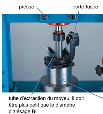
3. le roulement se sépare en deux : une des bagues intérieures reste sur le moyeu, l'autre partie du roulement reste dans le porte-fusée
