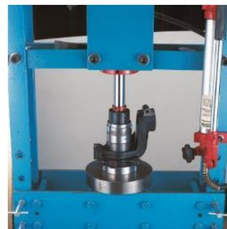
\*\*le diamètre du tube doit correspondre à la surface de poussée sur la bague extérieure.
