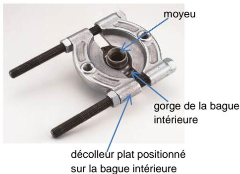
5. placer l'extracteur sous la presse en appui sur un tube ou des cales. Et pousser avec le tube de diamètre approprié utilisé précédemment ( voir point 2) afin de le dégager de la bague intérieure.
