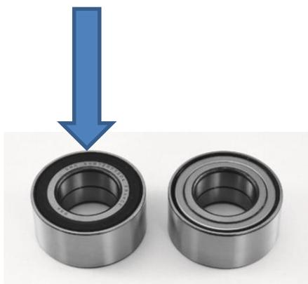
13. Monter l'ensemble constitué sur le véhicule. Lors de la mise en place de la transmission dans le moyeu veiller à ce qu'aucun choc ne se produise : l'axe de l'embout de transmission pourrait détériorer le codeur magnétique. Avant d'emmancher la transmission, nettoyer le codeur magnétique. Remonter le disque et l'étrier de frein. A l'aide d'une clé dynamométrique, serrer l'écrou de transmission neuf au couple de serrage recommandé par le constructeur.
