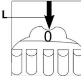
FIGURA 5 Marcas de referencia sobre el volante de inercia del motor. Verificar la correcta alineación de las marcas de fase I.
