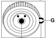
FIGURA 2 Aflojar el tornillo de fijación B, girar el tensor de correa sobre el excéntrico en sentido de las agujas del reloj, utilizando la llave de regulación C.
