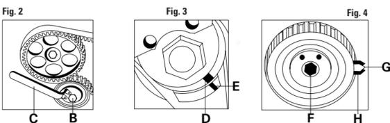
FIGURA 2 Allentare il bullone di bloccaggio B e ruotare in senso orario il tendicinghia utilizzando la chiave C agendo sull'eccentrico di registro.
