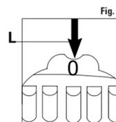
FIGURA 5 Segni di riferimento sul volano: verificare il corretto allineamento delle tacche di fase L.
