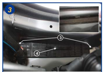
Actionner les 2 pattes de fermeture situées aux deux extrémités du couvercle du boîtier filtrant (3) et tirer fortement sur la poignée centrale (4) pour retirer le couvercle. Le filtre est alors accessible (voir encadré).
