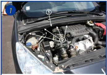
Le filtre d'habitacle est situé sous le capot moteur, coté passager, sous la baie de pare-brise (1). Retirer les 4 clips plastiques (2)
