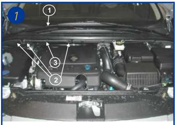
Le filtre d'habitacle est situé sous le capot moteur, sous la baie de pare-brise, coté passager. Ouvrir le capot moteur, localiser le boitier (repère 1) Retirer le 3 clips plastiques (repère 2) et extraire le carter souple (repère 3)
