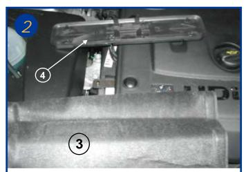
Le boitier filtrant se trouve derrière une trappe, (repère 4) il suffit juste de retirer cette trappe en exerçant un traction vers soi.
