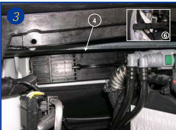
Le boîtier habitacle est alors visible (4), exercer une traction sur la trappe et la retirer (6)
