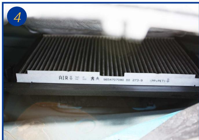
Extraire le filtre usagé et le remplacer. Aucun outil n'est nécessaire à son remplacement. Le remontage s'effectue dans l'ordre inverse du démontage.
