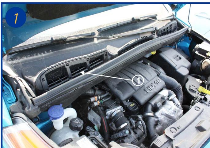
Le filtre d'habitacle est situé sous le capot moteur, côté passager devant la baie de pare-brise (1).
