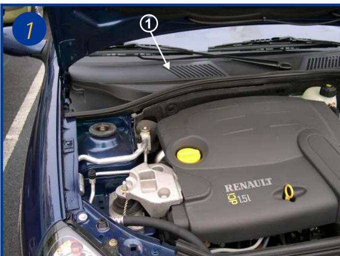
L'élément filtrant est situé sous le capot moteur sur la baie du pare brise coté passager (voir flèche 1).
