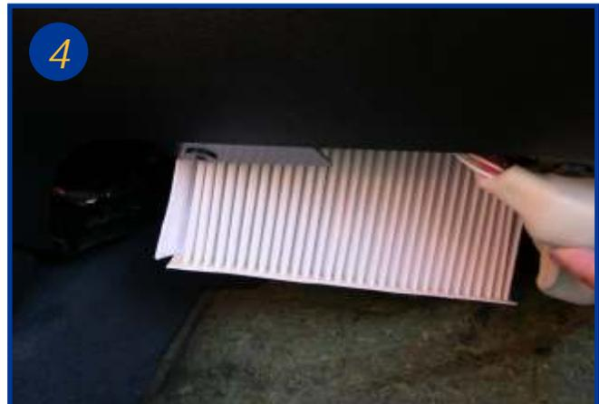
Extraire l'élément filtrant en le tirant vers le bas. Le remontage s'effectue dans l'ordre inverse du démontage.
