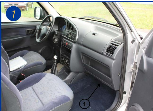
L'élément filtrant est situé dans l'habitacle du véhicule côté passager sous la boîte à gants (voir flèche 1).. Ouvrir la porte côté passager.
