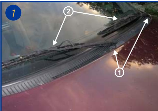
1 L'élément filtrant est situé dans le boîtier d'aération sous le capot moteur du côté passager. Ouvrir le capot moteur Retirer du boîtier d'aération les conduites d'arrivée d'eau de chaque essuie glace (flèche 1). Refermer le capot moteur Retirer également les 2 balais d'essuie glace (flèche 2). Ouvrir le capot moteur.
