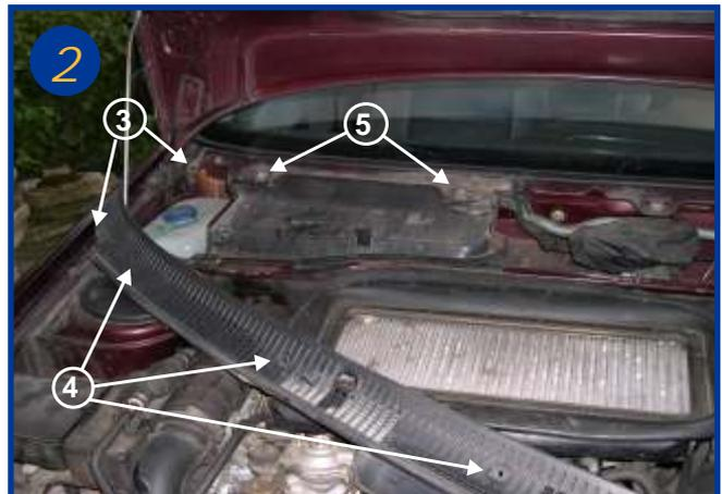
2 Retirer la grille d'auvent après avoir oté la pince de fixation (flèche 3) et dévissé les 3 vis cruciformes (flèche 4). Dévisser ensuite le carter du ventilateur fixé par 2 vis à empreinte Torx (flèche 5). Retirer ce carter.
