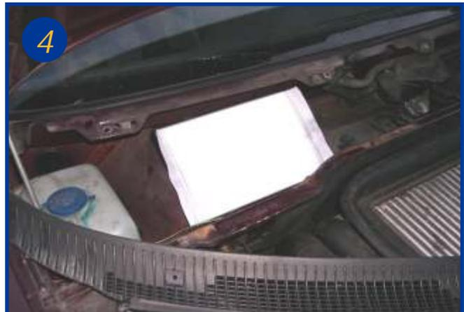
4 Saisir l'élément par les languettes, toute manipulation de l'élément devra être faite le joint en mousse vers le bas Assurer un bon appui avec la partie inférieure en pressant légèrement sur le joint et faire basculer l'ensemble Le remontage s'effectue dans l'ordre inverse du démontage.
