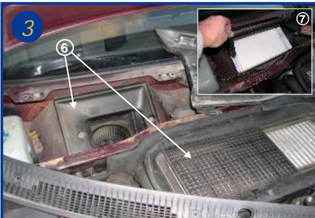
3 Si votre véhicule n'est pas déjà équipé d'un filtre à air habitacle, retirer la grille d'aération et le boîtier (6) et placer un cadre prévu à cet effet par Peugeot en lieu et place (7) Extraire l'élément filtrant usagé
