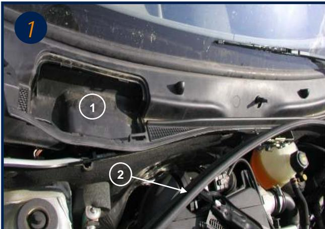
L'élément filtrant est situé sous la baie de pare brise côté passager . Ouvrir le capot moteur.
