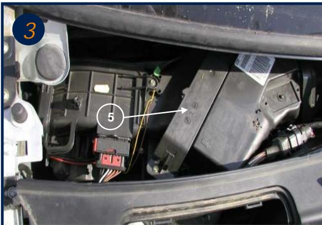
Dévisser ensuite le couvercle du boîtier du filtre sur le climatiseur (flèche 5).
