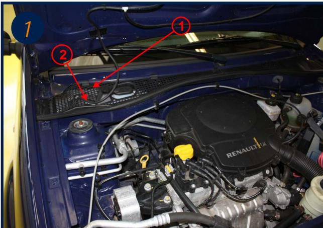
Le filtre d'habitacle est situé sous le capot moteur, sous la baie de pare-brise côté passager (1). Ouvrir le capot moteur et détacher le conduit d'alimentation du lave glace (2).
