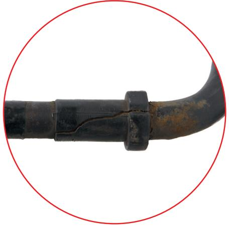
**PL Uwaga:** W przypadku uszkodzeń stabilizatora (patrz zdjęcie) Proszę wymieniać kompletny stabilizator a nie jego łożyskowanie (gumy stabilizatora).
